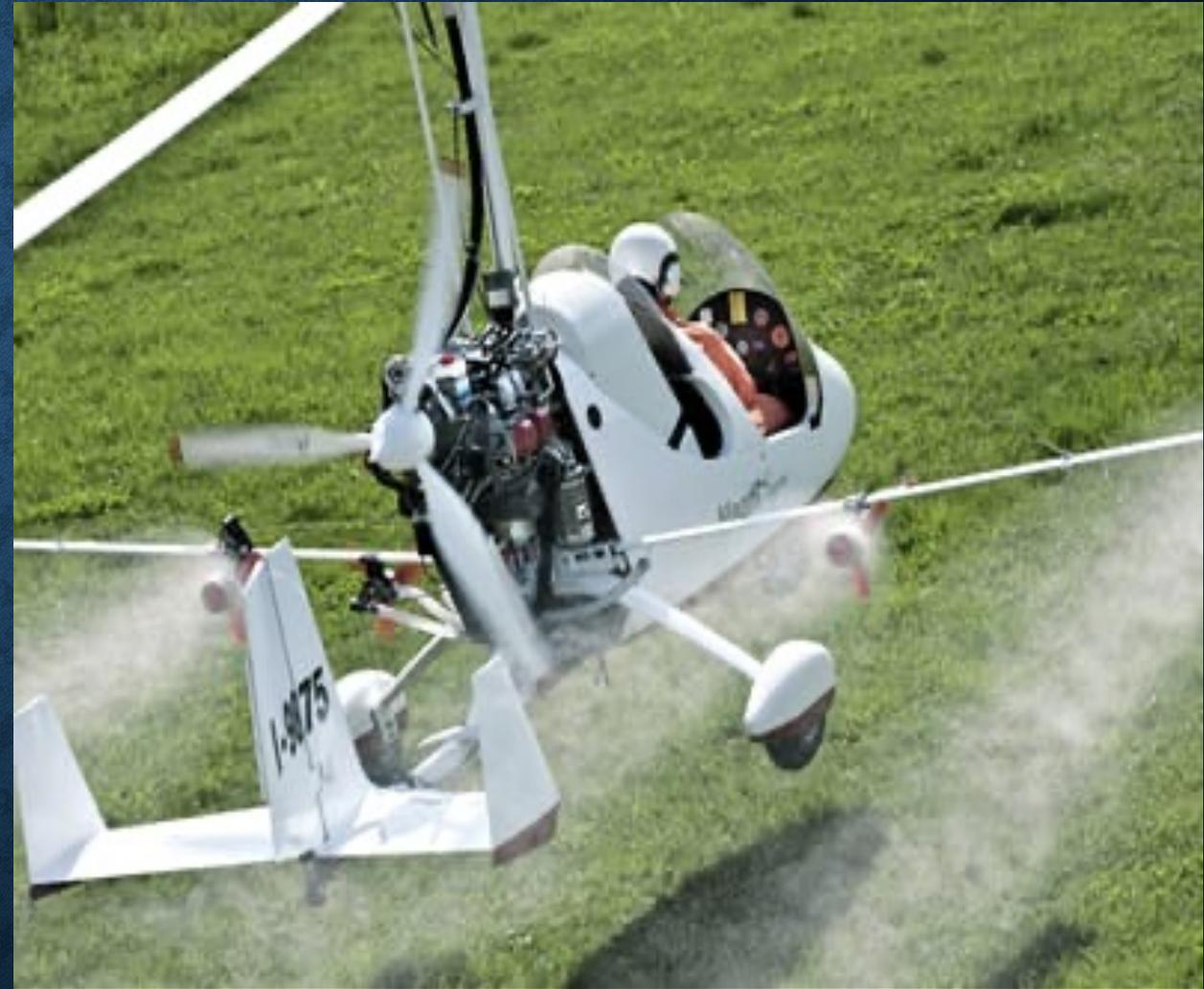
El interior del habitáculo delantero está equipado con un portabotellas y un portalápices con un forro especial para evitar que se caigan. Con una capacidad de combustible de 72lt, el Magni M16 tiene tres horas y media de autonomía a una velocidad de crucero entre 120 y 150 km/h. El M16 Tandem Trainer es robusto, confiable y tiene un rango de vuelo considerable. Es fácil de controlar y manejar. Es divertido de volar, y es una excelente plataforma para vuelos de entrenamiento y de ocio.
